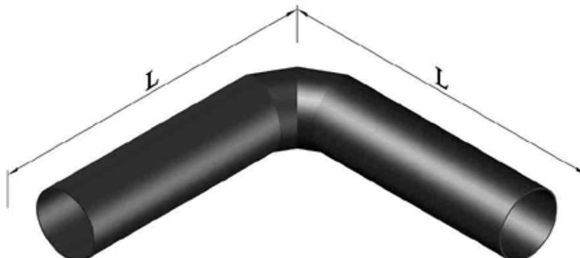
Les coudes de montage sont utilisés pour assurer une seconde isolation des coudes médians qui ont été soudés sur le chantier par le responsable de la pose des conduites. Les coudes de montage sont fabriqués à partir de tubes HD-PE non thermorétractables. L'étanchéité frontale est assurée par des manchettes thermorétractables.
