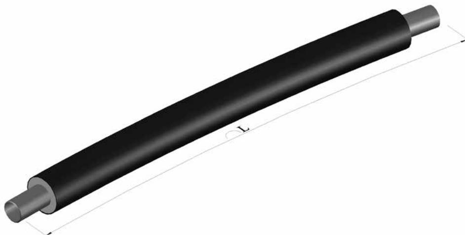
Les raccords cintrés sont des tubes en gaine plastique préisolés en usine qui sont fabriqués selon les spécifications du client. Ces raccords cintrés, qui se présentent sous la forme de tubes en gaine plastique arqués d'un grand rayon de courbure, servent à optimiser les changements de direction dans le tracé des conduites.
