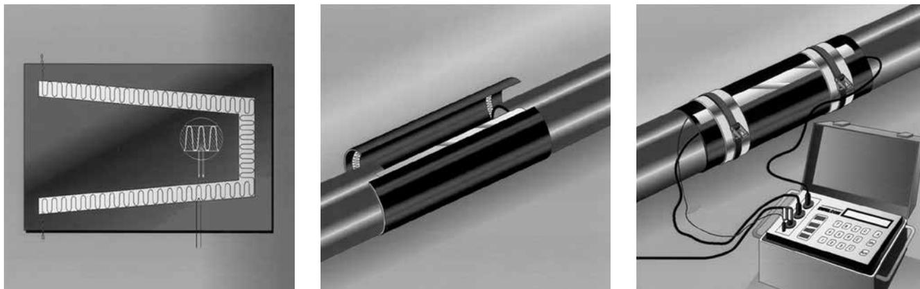
EWELCON est le nom protégé du manchon électro-soudable de la société BRUGG Rohrsysteme, destiné à la réalisation de raccords étanches à l'eau et au gaz entre tubes, et de préférence manteau PE-HD, pré-isolés (KMR), dans les domaines du chauffage à distance.
