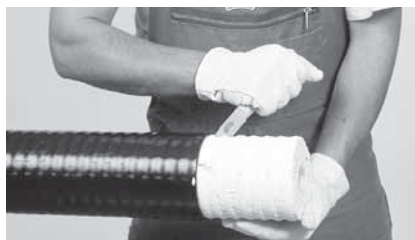
5 Enlever l'isolation sur la longueur (x, y, z). Attention : Le tube median ne le fait pas blesser !
