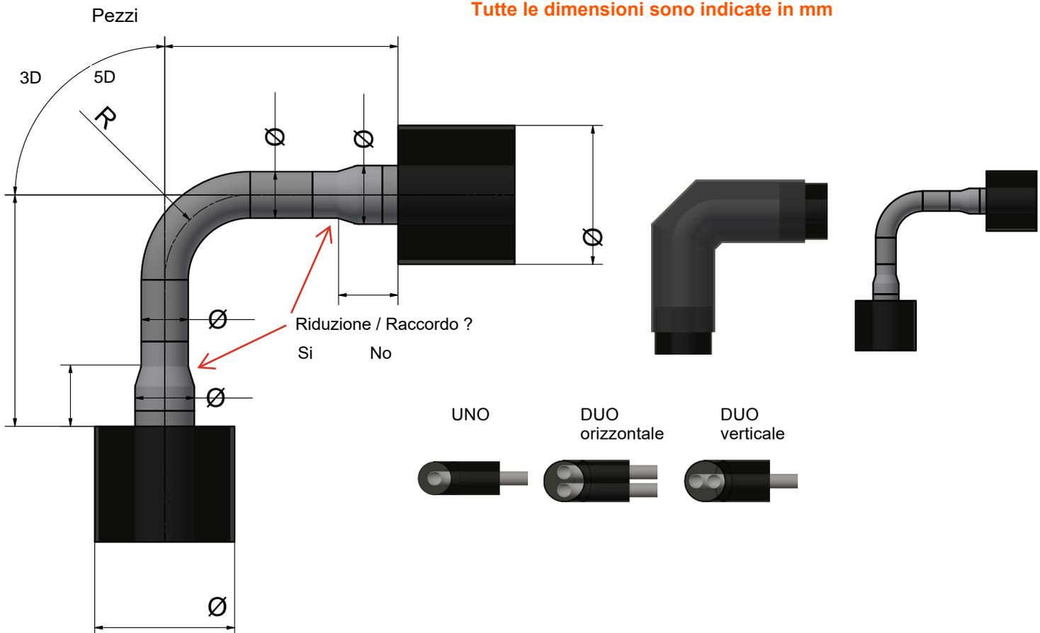
**Curve di montaggio PE-BG ..°**
